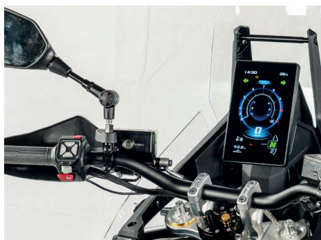
TFT displayet er stort og lest å ese, selv i direkte sollys. Vertikalmontert i ekte rallystil.
