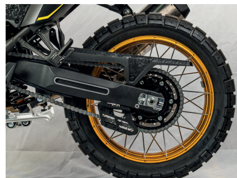
Elegant svinggaffel i aluminium med tradisjonell kjedejustering. Enkelt og effektivt.
